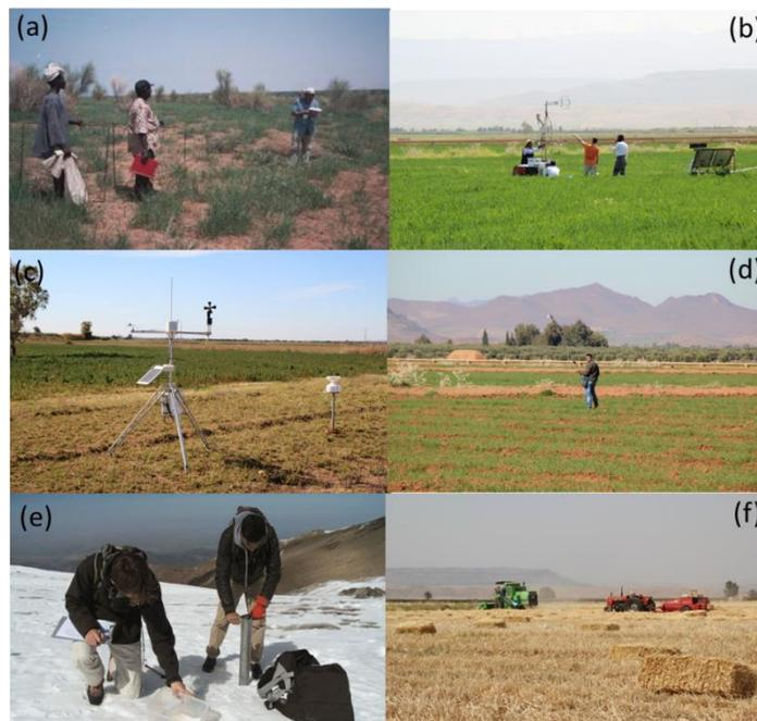
Figure 3 : (a) mesure de la masse aérienne herbacée dans le Sahel Malien ; (b) Station micro-météorologique (Observatoire Tensift, Maroc) ; (c) Station météorologique (Observatoire Tensift, Maroc) ; (d) Mesures des signatures spectrales d'un couvert de blé (Observatoire Tensift, Maroc) ; (e) Mesure de la hauteur et de la densité de neige (Observatoire Tensift, Maroc) ; (f) Mesures du rendements en grain (Observatoire Tensift, Maroc) .
