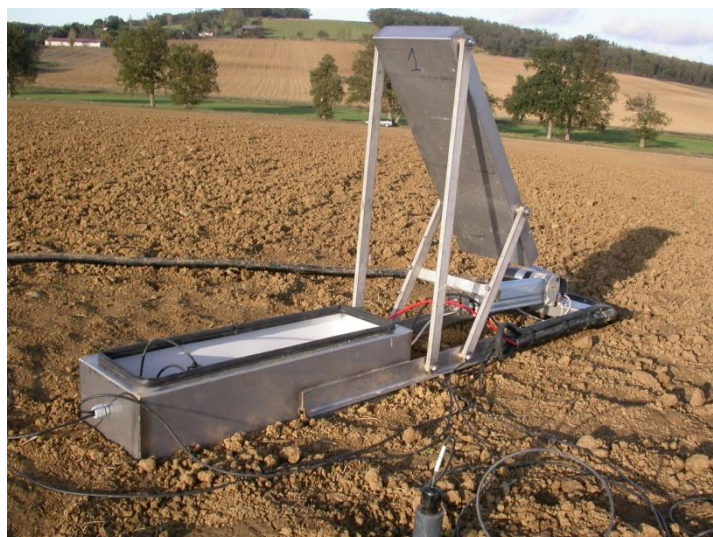
Figure 8.3 : Chambre automatique en inox pour la mesure des flux nets de N_2O et de CO_2 équipée d'une sonde de température et d'humidité à l'intérieur et à l'extérieur de la chambre.
