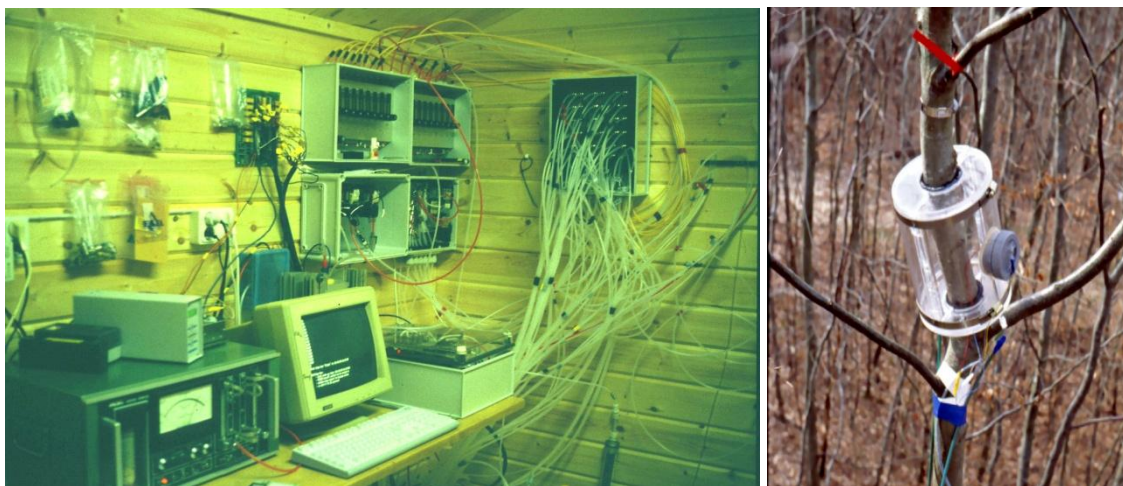
Figure A : Système automatisé pour la mesure de la respiration ligneuse à Flakaliden (gauche) et exemple de chambre de mesure à Hesse (droite).
