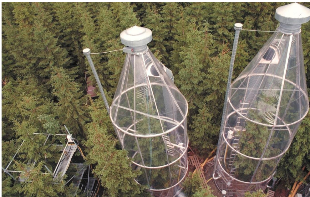
Figure B : Système « Whole tree chamber » permettant de contrôler la concentration en \text{CO}_2 , la température, le VPD et de mesurer les échanges nets d'eau et de \text{CO}_2 entre l'arbre et l'atmosphère de la chambre.
