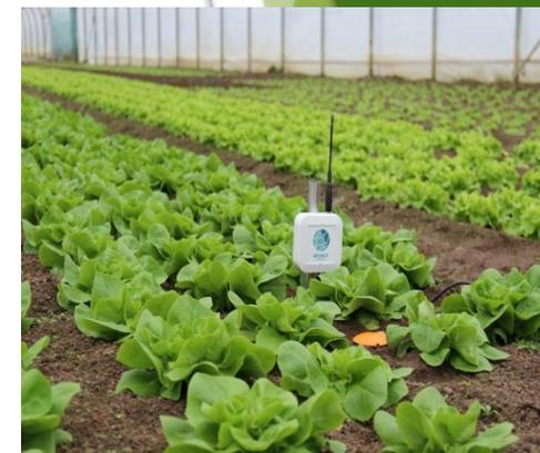
Pilotage à partir de tensiomètres ou sondes capacitives
